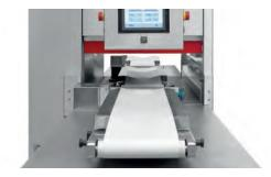
Una cinta de alimentación sincronizada sirve de ayuda durante la carga rápida y ergonómica de la máquina y es requisito indispensable para una ulterior automatización en la zona de carga.
