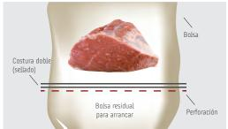
El **troquelado** permite retirar de un modo sencillo los excedentes de holsa tras la extracción de los envases.
