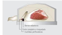
Las **cuchillas perforadoras** son necesarias para poder evacuar el envase cuando la apertura de la bolsa sobresale de la cámara.
